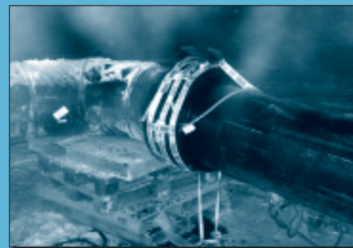
10. ábra: ELGEF Plus karmantyú működésének helyszíni tesztje sarkkörti körülmények között
